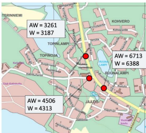
Kuva 10. Aikavälillä 20.2.-27.2.2017 (vko 8) tehtyjen liikennelaskentojen keskimääräinen vuorokausiliikennemäärä (W) ja keskimääräinen arkivuorokausiliikennemäärä (AW) ajon./vrk.
