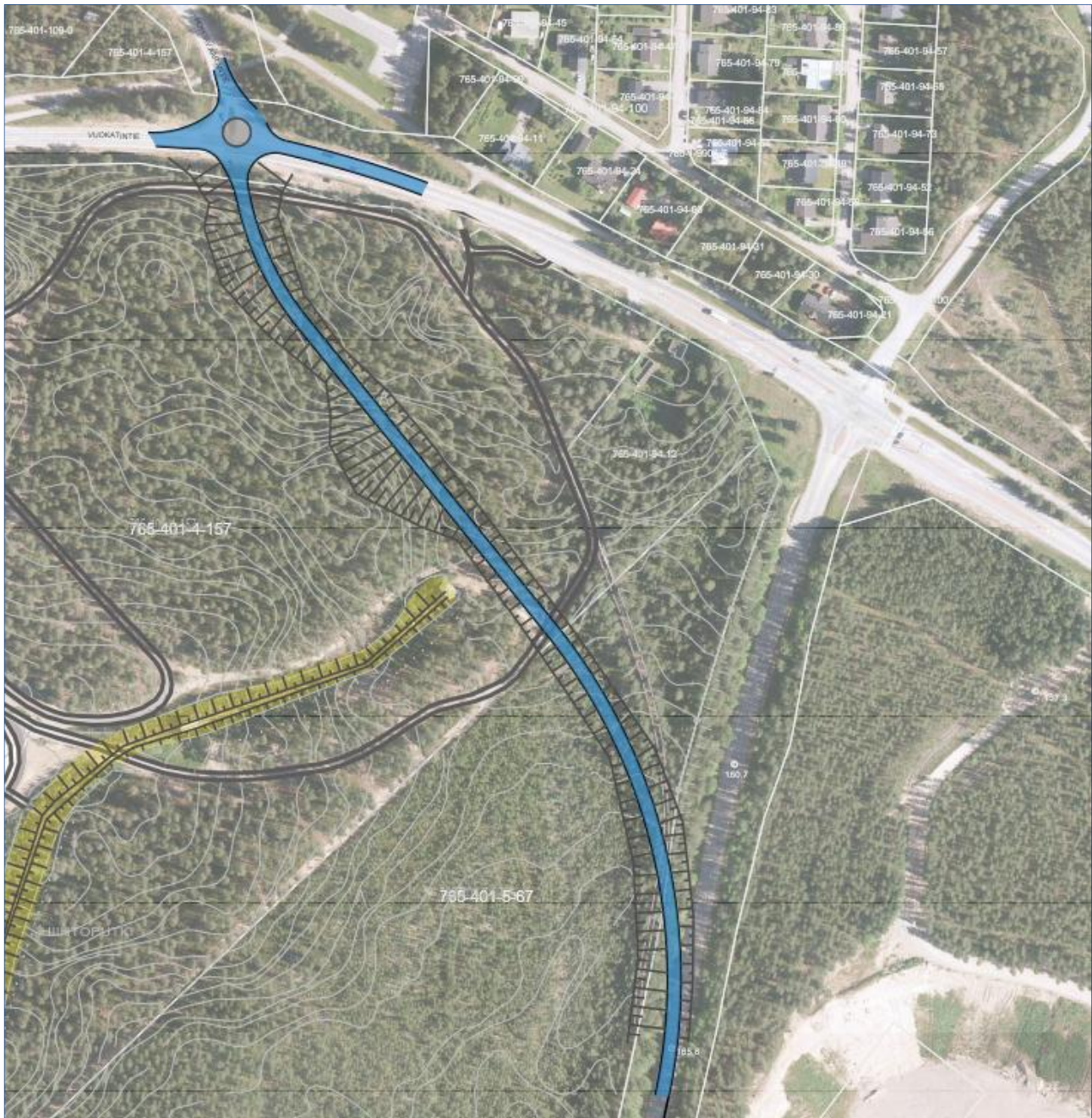
Kuva 29. Periaatekuva Nurmeäntien ja Pohjavaarantien liittymien yhdistämisestä. Kiertoliittymän vaihtoehtona on liikennevalo-ohjattu liittymä.
