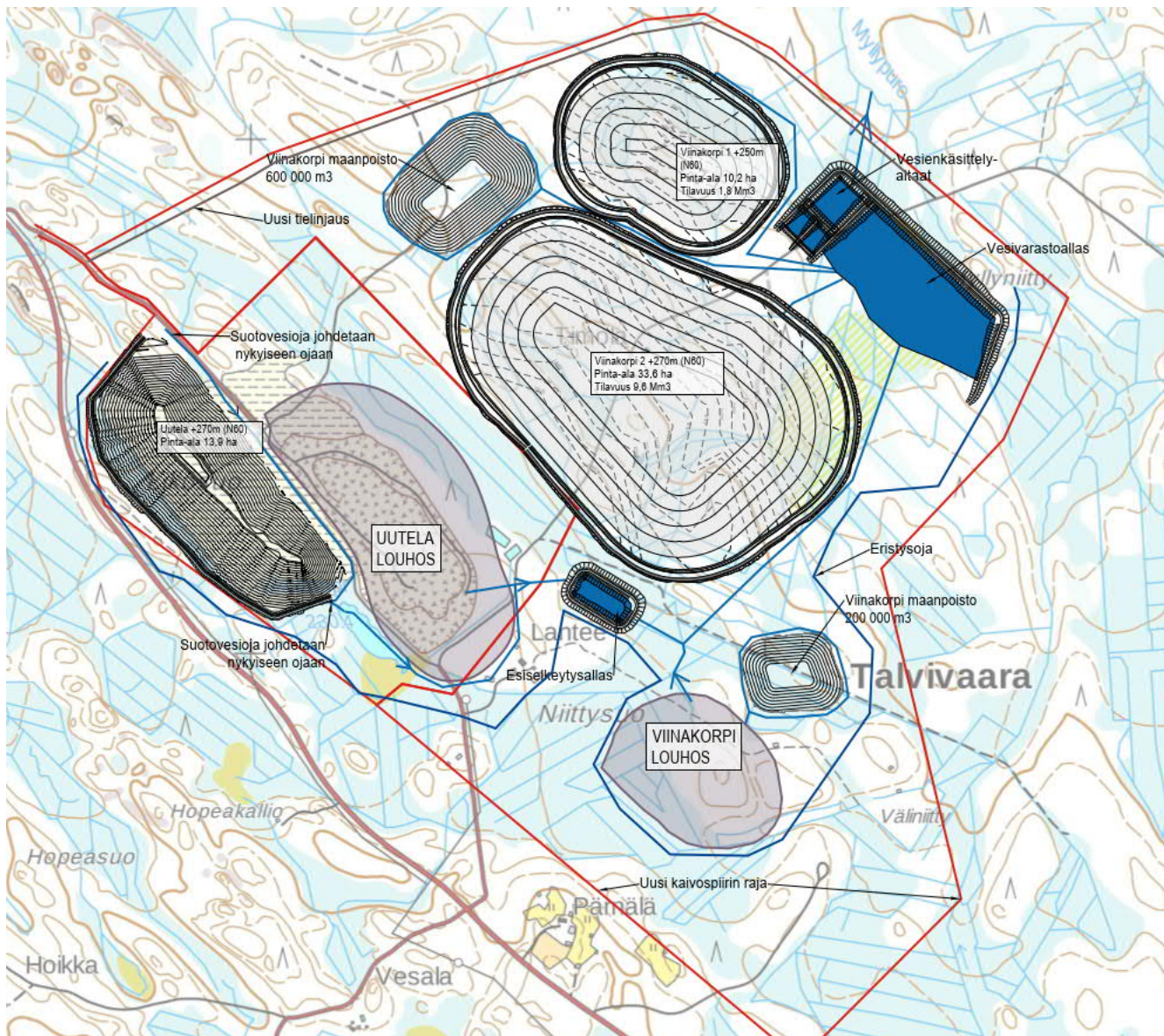
Kuva 2-2 Uutelan kaivoksen ja sivukivialueen laajennuksen suunnitelma.
